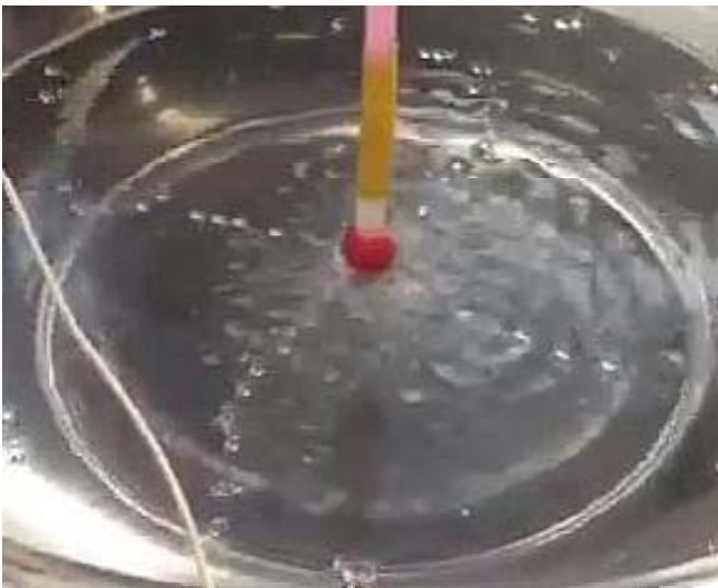
図 9 20Hz の 2 次振源 20Hz の振動数で 4 方向の水玉
