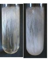
たいていは落ちてくる結晶は針状です。しかし、この溶液を入れたいくつもの試験管にスポイトで1滴ずつ純水を滴下し、水分の割合を調整すると、針状の結晶とは異なる結晶が落ちてきます。
