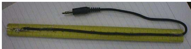
図25 アンテナの先を定規に固定し、測定状態の安定化を図った。
