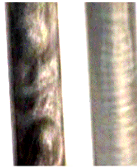
図4 左がカルマンの渦 右はテーラー渦 水流を見るために薄い石けん水にアルミ粉を入れ、試験管の回転を急に止めると横縞が現れる時の渦です。
