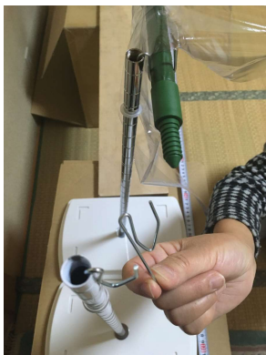
カーテンフックをポールに差し込み園芸用支柱を固定している様子
