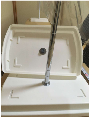
穴を開けボルトとワッシャーで固定の様子
